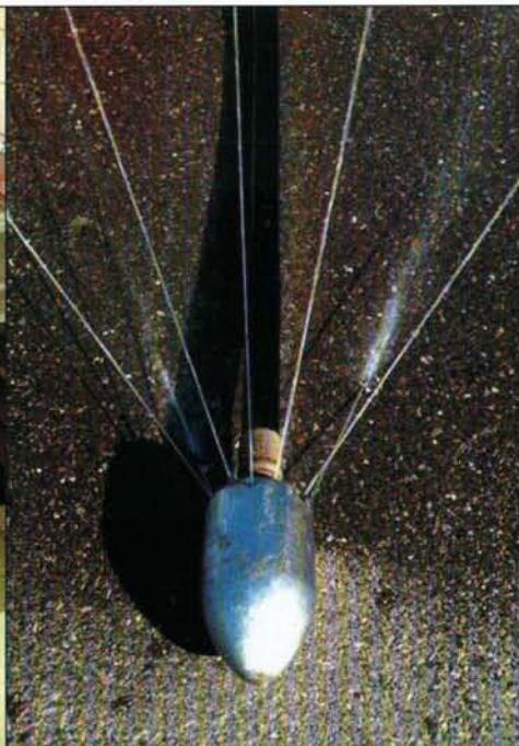
Hochdruckdüse zur Kanalreinigung
