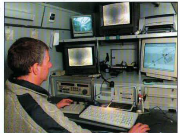
Der Bedienungs- und Beobachtungsstand im Inspektionsfahrzeug
