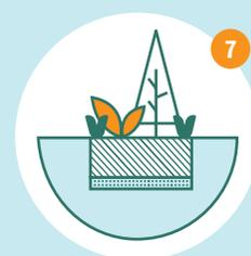
**Déposer un remblai de qualité : mettre une couche minimum de sable au fond de la tranchée, et disposer au moins 30 cm de terre arable de bonne qualité, pour assurer la reprise de la végétation.**
