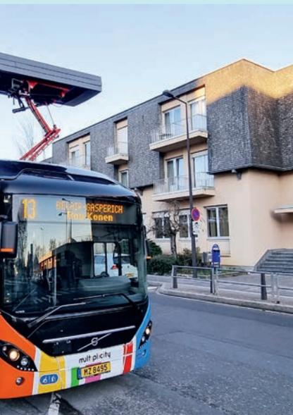
1. Les **deux bornes de recharge** au Cents et près du centre hospitalier permettent de charger les bus 100 % électriques des lignes 9, 13, 14 et 24.
