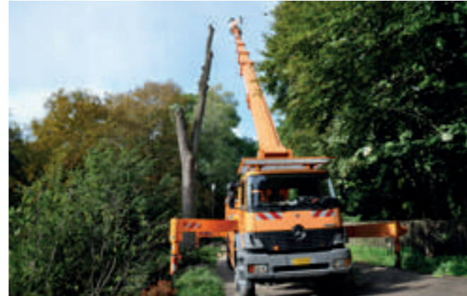
Große Hubarbeitsbühne bei Fällarbeiten im Stadtpark, 45 Meter maximale Arbeitshöhe.
