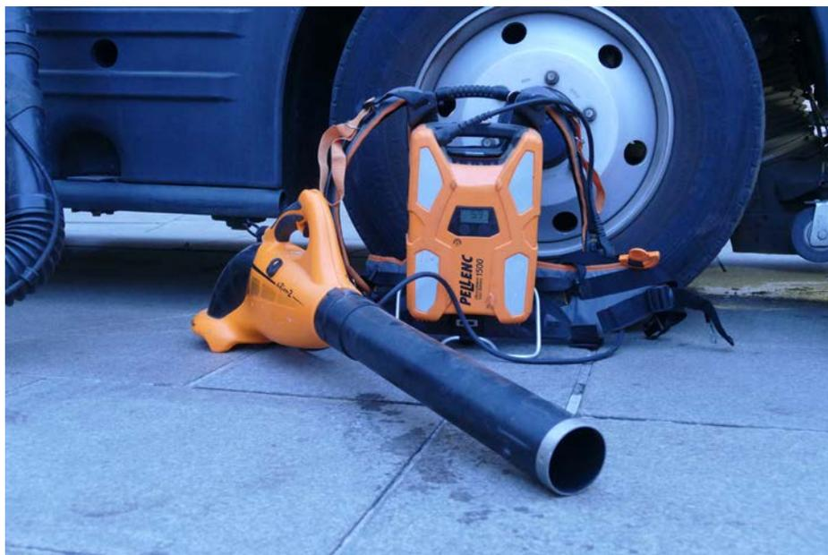
*Souffleuse électrique avec « batterie » en forme de sac à dos*
