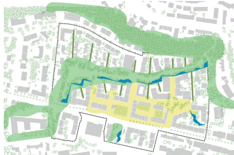
Retenir les eaux pluviales en amont des réseaux.
