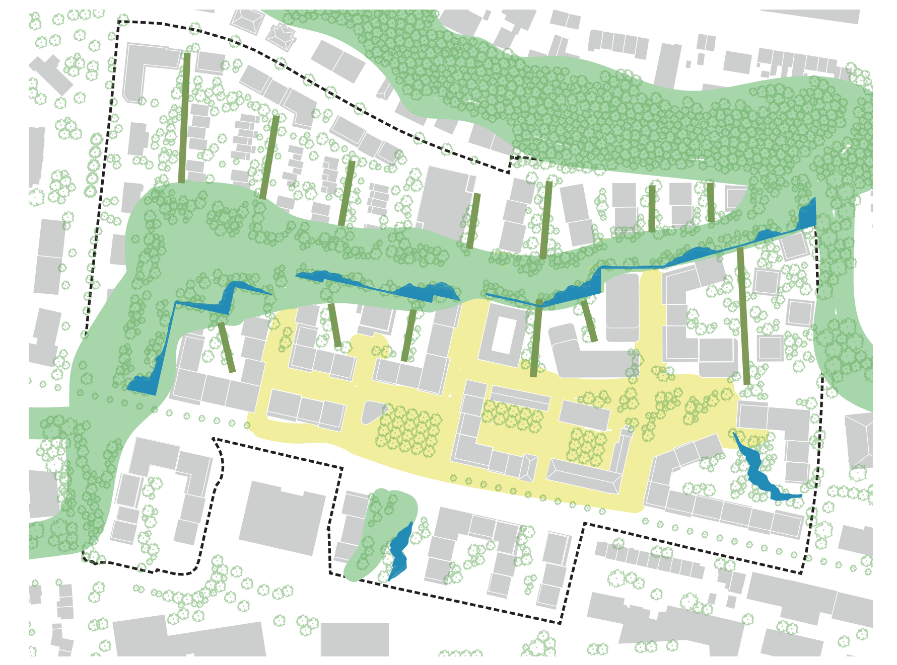
Concept des espaces libres 1:2500 | Espaces verts et rétention des eaux pluviales
