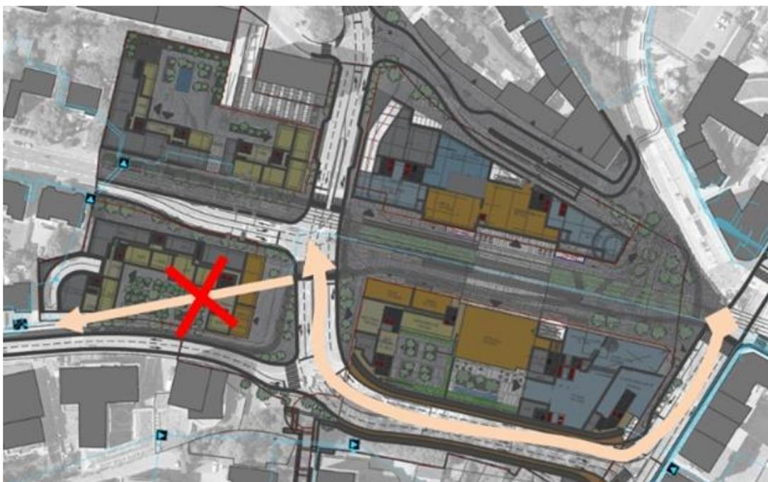
*En beige le câble à supprimer ainsi que la fibre optique à dévier via le multitubulaire*
